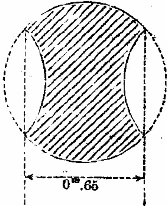
» L'instrument dont j'ai fait usage à Marseille est le grand télescope Foucault, de 80 centimètres de diamètre, muni d'un écran lunulaire; les lunules sont limitées par des cercles égaux de 80 centimètres; leurs grands axes sont parallèles et distants de 65 centimètres.
